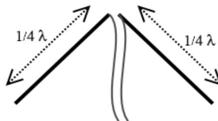
Inverted-V -dipoli (yksi kiinnityspiste)
