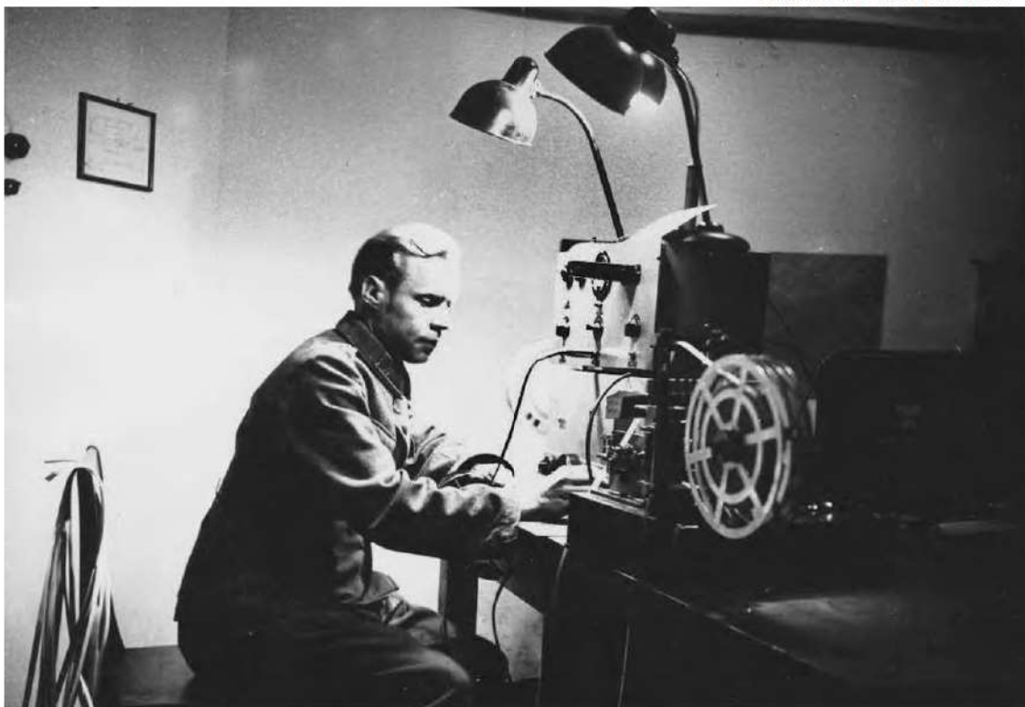
Diplomaattiviestit sähkötettiin erittäin suurella nopeudella. Niiden vastaanottamiseen käytettiin tällaista piirturia, undulaattoria. Morsemerkit tulkittiin sitten käsityönä tulostusnauhalta.
