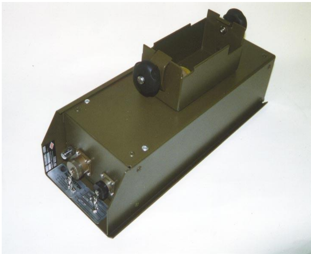
Kuva 2.1 WPU (Winch Power Unit), joka sisältää kotelon lisäksi tasavirtamoottorin, vaihteiston, tarvittavat häiriönpoistokomponentit moottorille, sekä kiinnittimet, joilla WPU voidaan kiinnittää vinssiin. (kuva: Mastsystem)
