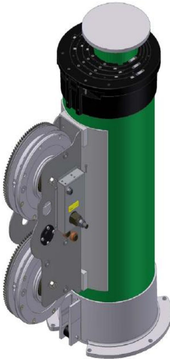
Kuva 1.4. Tuplarumpuvinssi EXB-mastoon kiinnitettynä. Molemmat rummut ovat yhteydessä mekaanisten jousten ja hammaspyörien välityksellä vinssin sisään menevälle akselille, joka näkyy vinssin oikealla sivulla. Hihnat eivät sisälly kuvaan. (kuva: Mastsystem)
