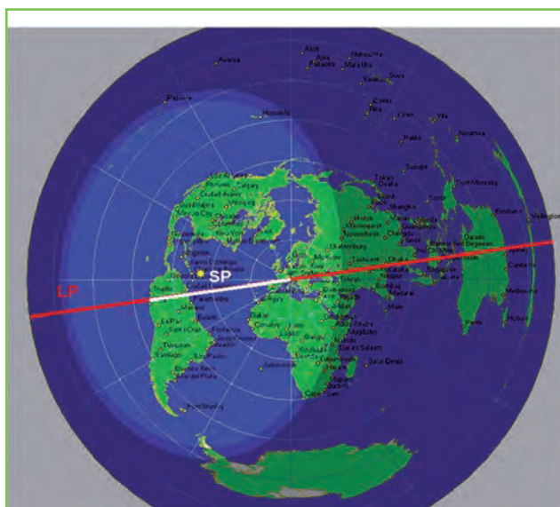
Fig. 1 - Mappa azimutale per il beacon OA4B, che mostra il long path (segmento rosso) e lo short path (segmento bianco). La distanza LP è di circa 29.000 km, e lo SP è di 11.000 km. La linea retta rossa e bianca è il gran cerchio che collega il beacon con la mia stazione
