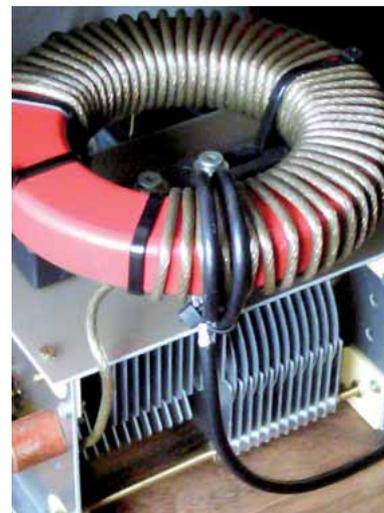
Bild 3: Die magnetisch abgeschirmte Einkoppelspule
