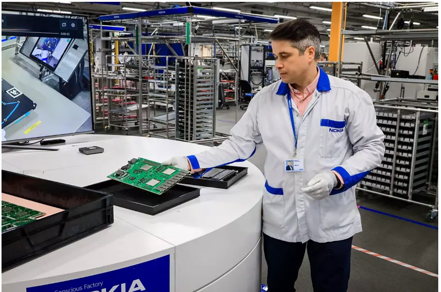
Nokian Oulun-tehtaan johtaja Heikki Romppainen esittelee 5g-tukiaseman kantataajuuskorttia, jonka toiminnan keskipisteessä ovat uudet järjestelmäpiirit. KUVA: JUKKA GRÖNDAHL / HS
