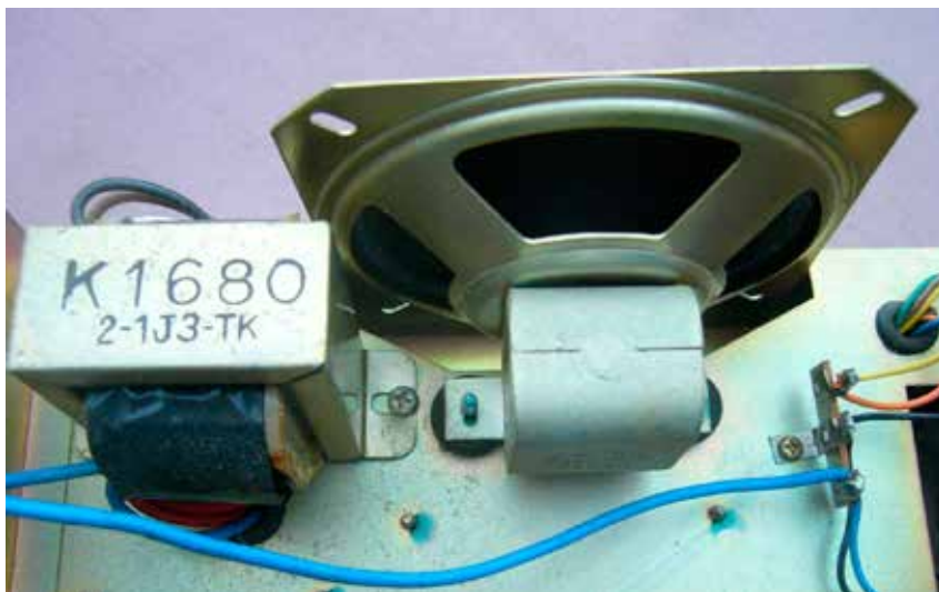
Högtalaren är monterad i chassiet med gummibussningar.
