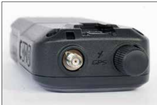
Den inbyggda GPS-mottagaren med sin antenn ligger i ovankanten av IC-R30 mellan SMA-antennkontakten och inställningsratten.
