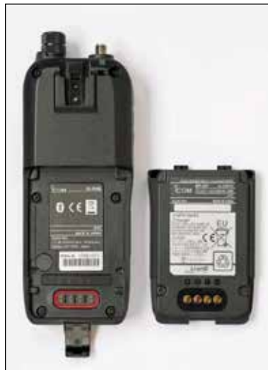
Batteriet som levereras med IC-R30 skjuts in och knäpps på plats på mottagarens baksida. Alternativt kan man som tillbehör köpa en batterihållare för strömförsörjningen.
