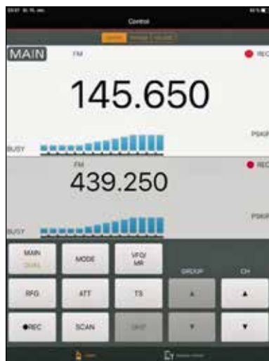
Den kostnadsfria smarttelefon-appen RS-R30 tillåter fjärrstyrning av grundläggande funktioner på IC-R30 via blåtand.
