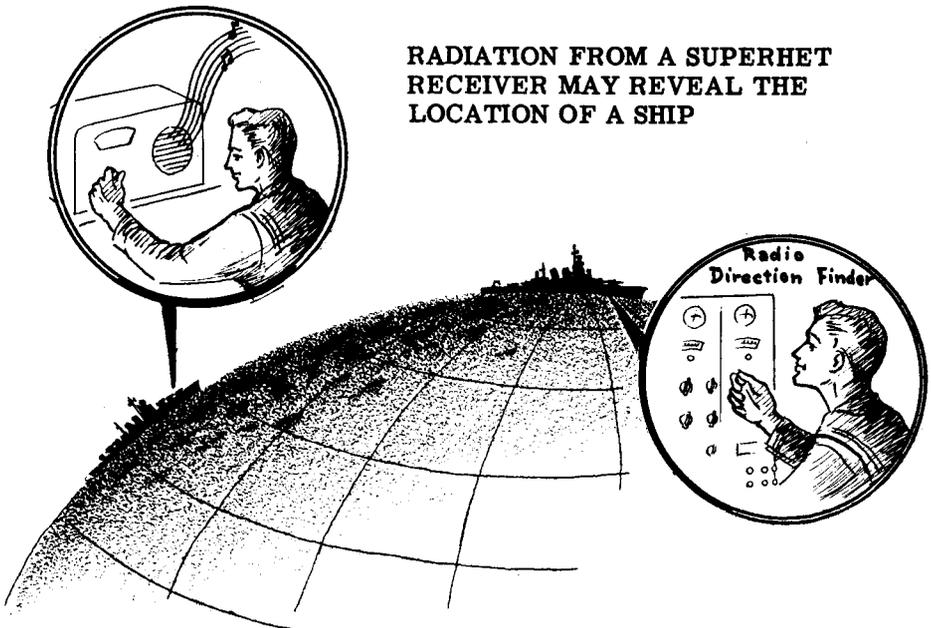
**RADIATION FROM A SUPERHET RECEIVER MAY REVEAL THE LOCATION OF A SHIP**
