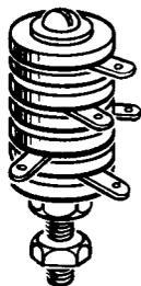
**HALF-WAVE DRY METAL RECTIFIER CIRCUIT**
